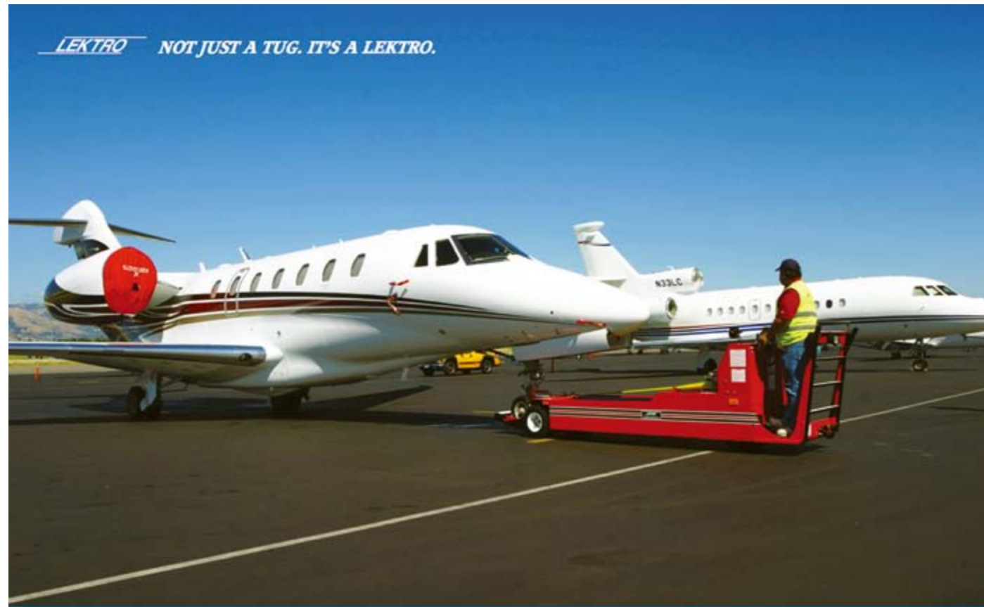
公务航空专用的无托杆电动飞机牵引车
